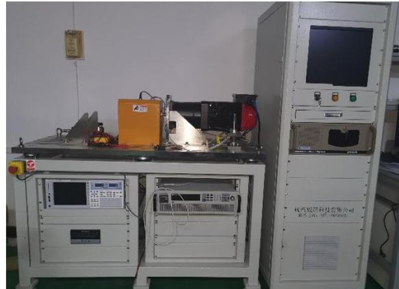
(b) 3kW 电机测功机平台
