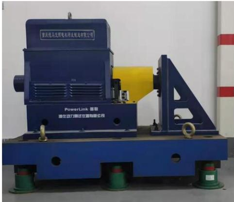
(a) 30kW 电机测功机平台
